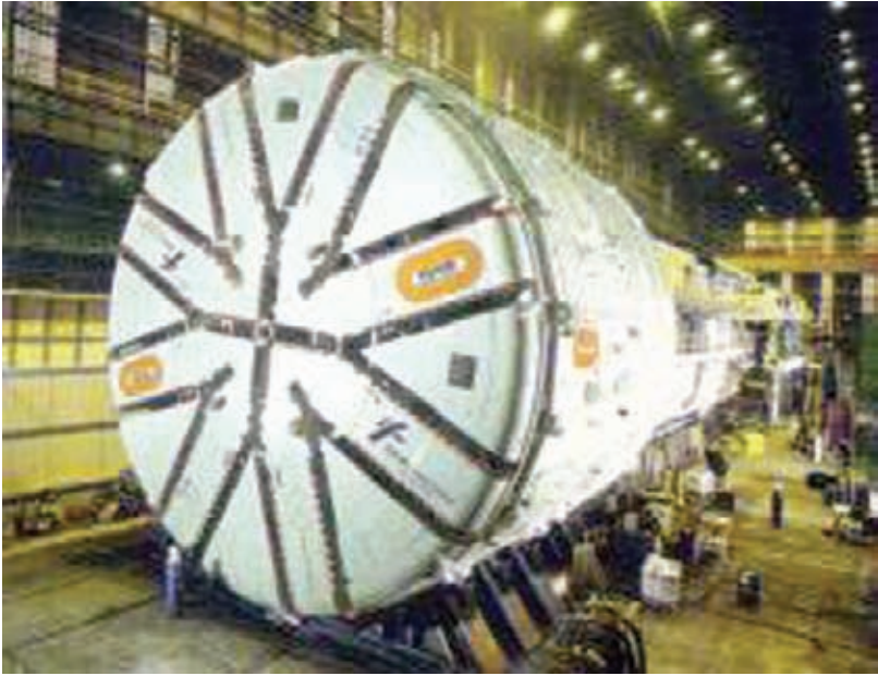
Головная часть с ротором тоннельнопроходческого механизированного комплекса марки Herrenknecht, изготовленного в Германии. На него возложена главная функция по сооружению тоннелей в ходе выполнения «Государственной программы по развитию Бакинского метрополитена в 2011—2015 годы».
